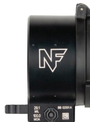
Le prisme cale offre un décalage optique de 50 MOA/14,5 MRAD ou 100 MOA/29 MRAD. Chaque unité est mesurée et étiquetée avec le décalage optique exact pour une précision répétable. Si un déplacement supplémentaire est nécessaire, deux prismes peuvent être montés en ligne pour créer un décalage optique égal à la somme de leurs valeurs individuelles marquées.
