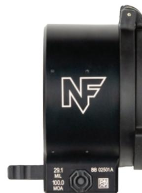
Il prisma a cuneo è disponibile in 50MOA/14.5MRAD o 100MOA/29MRAD di spostamento ottico. Ogni singola unità viene misurata ed etichettata con l'esatto spostamento ottico per una precisione ripetibile. Se è necessaria una corsa maggiore, è possibile montare due prismi in linea per creare uno spostamento ottico uguale alla somma dei valori individuali contrassegnati.
